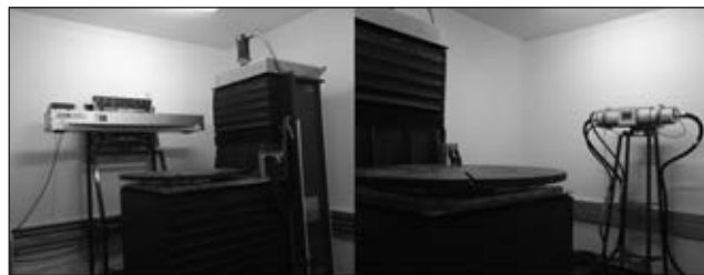
Figura 1. Instalaciones de tomografía. A la izquierda el detector y a la derecha el tubo de RX.
